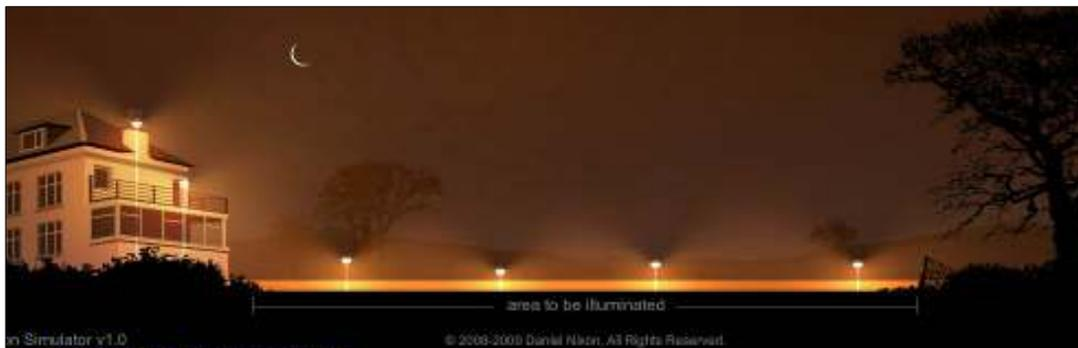
**Fig. 2.** Simulação do aspecto do céu noturno, iluminado por candeeiros (rigorosamente chamados *luminárias*) de distribuição semi-limitada. Estes candeeiros ainda permitem a emissão de luz até cerca de  $40^\circ$  acima da horizontal. São pouco melhores do que os da Fig.1 (em baixo) e ainda bastante poluentes. Imagem realizada com o simulador disponível em <http://www.britastro.org/dark-skies/simulator.html> (Guilherme de Almeida, 2011).
