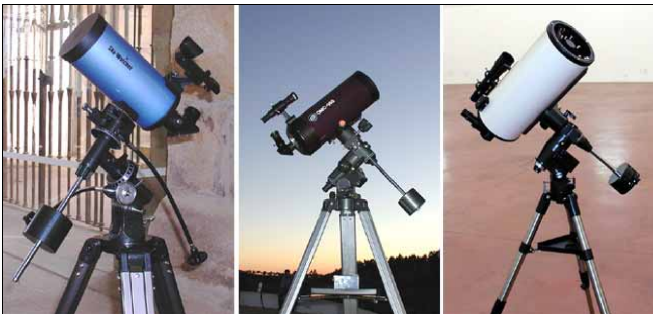
Figura 4- Alguns exemplos de telescópios catadióptricos (neste caso do tipo Maksutov-Cassegrain).
