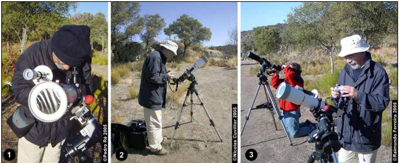
Figura 3- O autor enquanto obtinha algumas das imagens: 1- com gorro para o frio, ainda cedo, a preparar o telescópio e alinhar o buscador (veja-se o filtro AstroSolar Baader na frente do telescópio e do buscador); 2 e 3- a fazer fotografias de diferentes momentos do eclipse. Fotografias de Pedro Ré, Nicolas Cuvillier e Raimundo Ferreira (2005).
