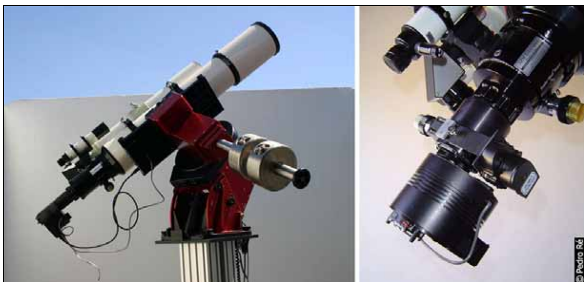
Figura 19- Paramount ME, TMB 152 mm F/8, Takahashi FS102, SBIG ST-10XE (esquerda). Focador FeatherTouch + Robofocus (direita), sistema de focagem automática. Pedro Ré (2005).
