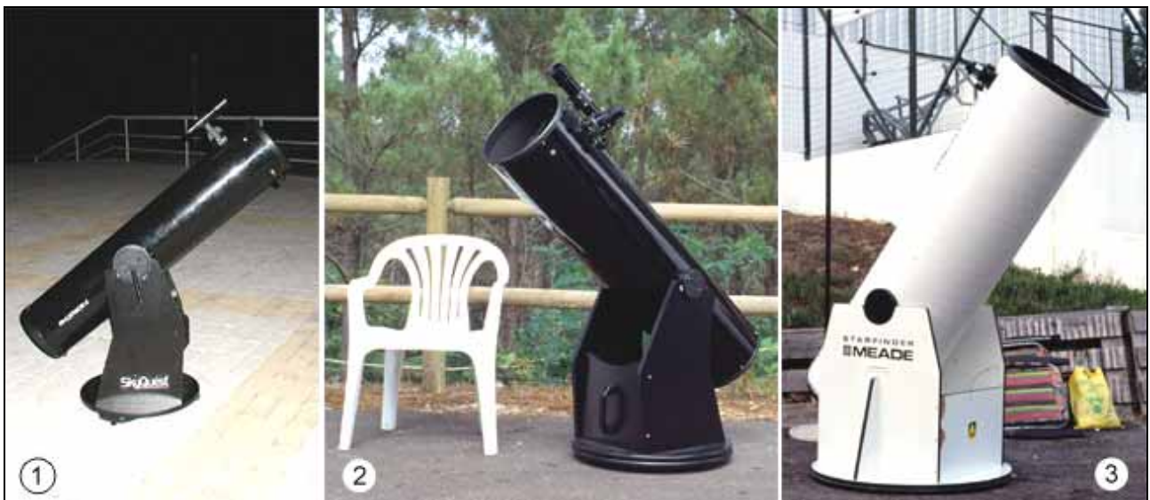
Figura 1- Exemplos de telescópios reflectores de Newton, sobre montagens altazimutais (neste caso montagens de Dobson (são por isso conhecidos como telescópios de Dobson ou telescópios dobsonianos).
