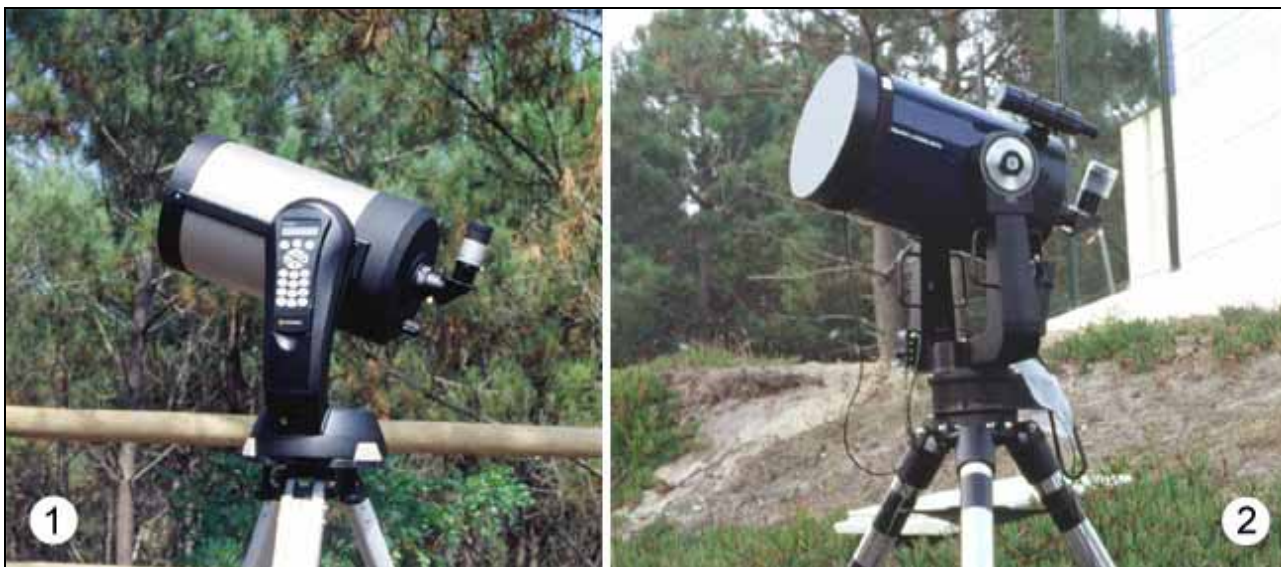
Figura 5- Exemplos de telescópios catadióptricos (neste caso são telescópios de Schmidt-Cassegrain).
