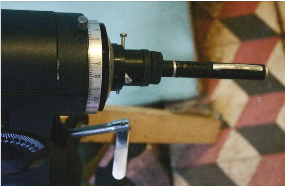
**Fig 2.** Pormenor do encaixe do ponteiro laser verde no tubo onde antes estava a óptica do buscador polar (Helder Geraldes, 2014).
