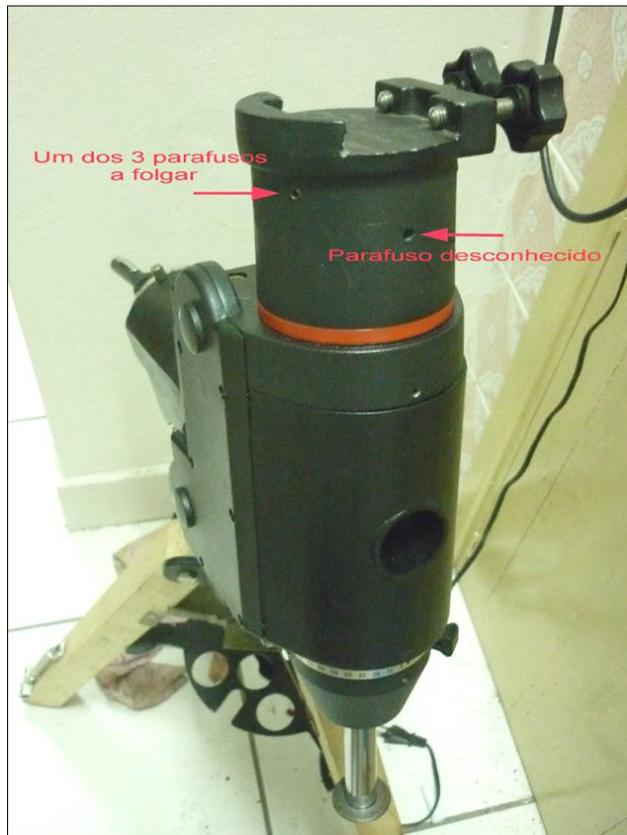
**Fig. 7.** Indicação dos parafusos que permitem rodar o suporte fêmea da dovetail (Helder Geraldtes, 2014).
