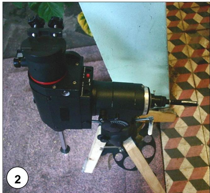
**Fig 4.** Fases do alinhamento do feixe do laser verde com o eixo mecânico de ascensão recta (eixo polar): **1-** feixe a sair da montagem; **2-** posição de alinhamento mecânico. (Helder Geraldes, 2014).
