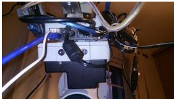
Aspecto do painel DEC da iOptron com saídas para a Canon, ZWO, voltagens para Canon e StellarMate
