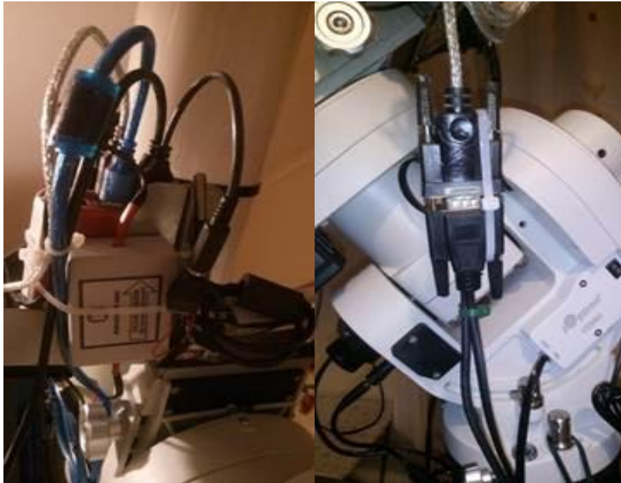
Aspecto das ligações ao StellarMate e ligação RJ4/DB9/USB da montagem iOptron
