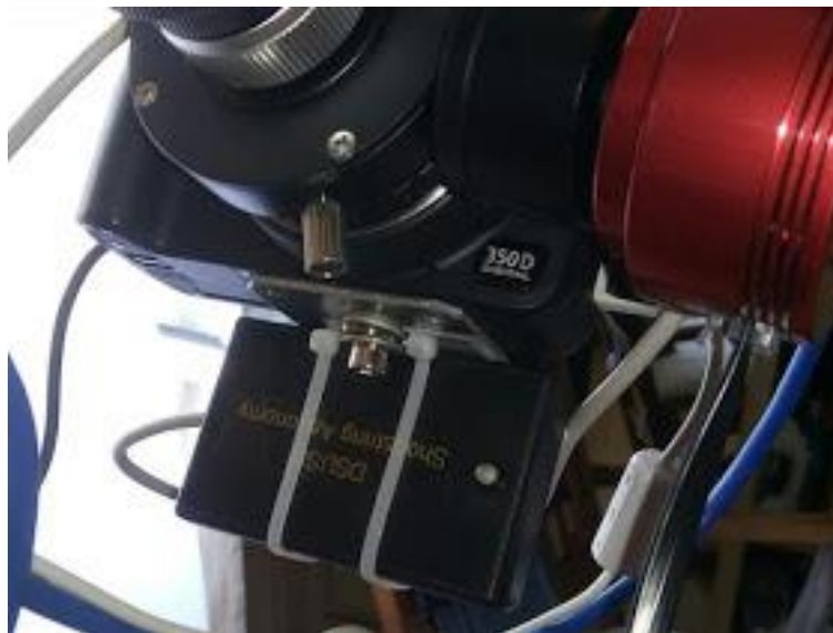
Esquema de suporte da DSUSB à Canon 350D
