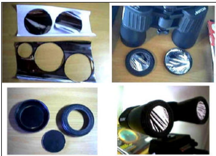
Figura 1- Filtros solares (Binóculo Hélios 10 x 50 Wide Angle).
