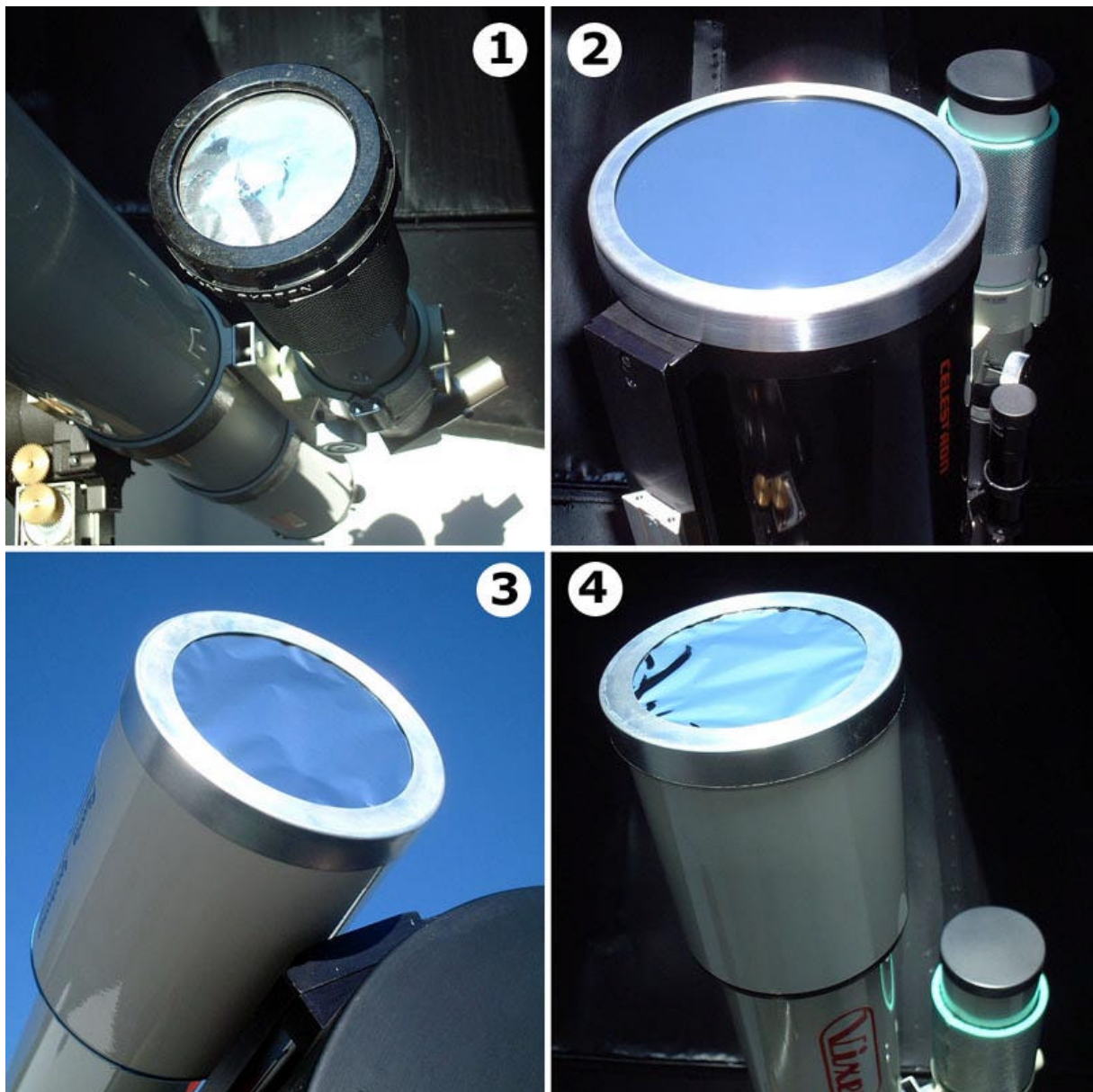
Figura 1- Filtros frontais para observação e fotografia Solar: 1- Mylar (Solar skreen) , montado num telescópio Takahashi FS60 ; 2- Thousand Oaks , montado num telescópio C8 , 3- Baader Planetarium , aplicado num telescópio Takahashi FS102 , 4- Baader Planetarium , montado num telescópio Vixen 102 . Pedro Ré (2001).
