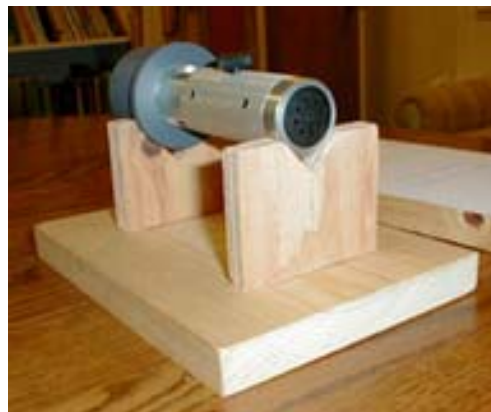
Figura 1- Bloco com apoios em V, sem o colimador laser montado (à esquerda) e com o colimador montado, pronto para o teste (à direita).
