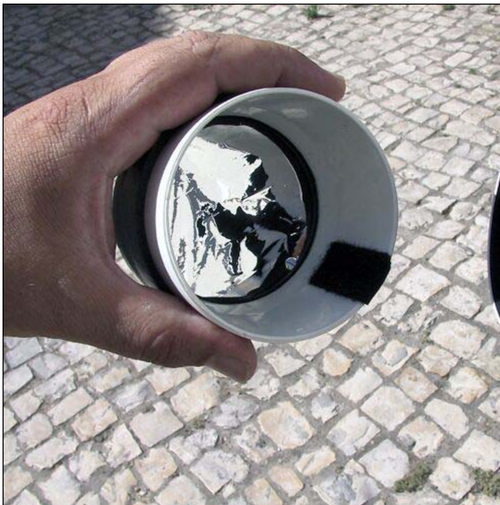
Figura 2- Este é o filtro solar da Baader Planetarium que utilizo correntemente. Está montado num tubo de escoamento de águas de chuva de 80mm. O bordo do lado do filtro está revestido com borracha para evitar o seu rompimento devido ao uso. A tira de velcro confere um ajuste à prova de furacões. O filtro não deve ser demasiado esticado segundo o fabricante o que pode prevenir um eventual rompimento. Consoante a intensidade de utilização e tratamento um filtro deste tipo pode durar entre 1 a 3 anos. Fotografia de Luís Carreira.
