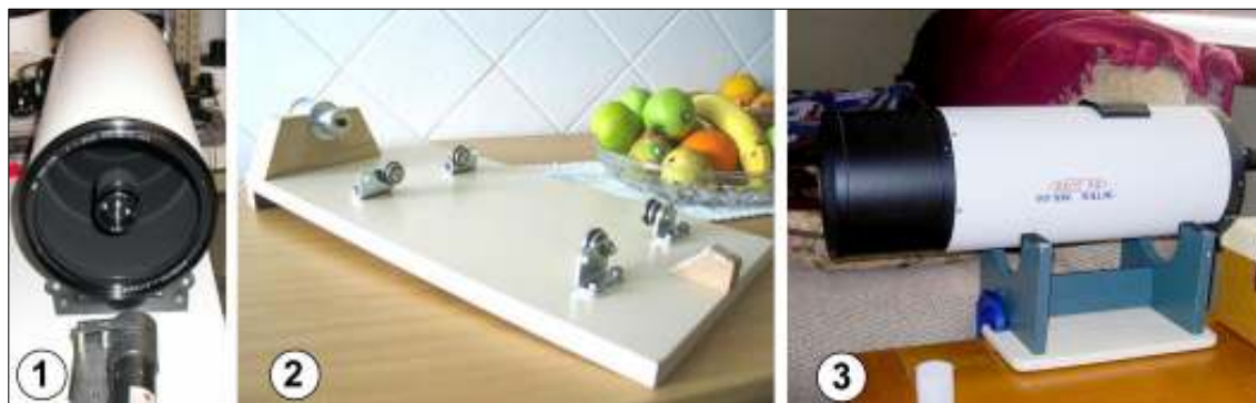
Fig. 8. Diferentes realizações do dispositivo de Yuri. 1- o original, utilizado na oficina de óptica da própria TEC ( Telescope Engineering Company ); 2- realização de Joaquim Rosa; 3- realização alternativa do observador norte-americano Jason Spencer, que não utiliza rodas, manipulando-se o tubo num banquinho voltado ao contrário (o encosto do tubo foi revestido com feltro, para não esfolar a pintura deste). Imagens da autoria dos respectivos autores.
