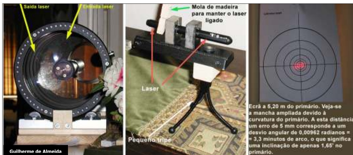
Fig. 7. Diferentes aspectos do dispositivo de colimação. Guilherme de Almeida (2007).
