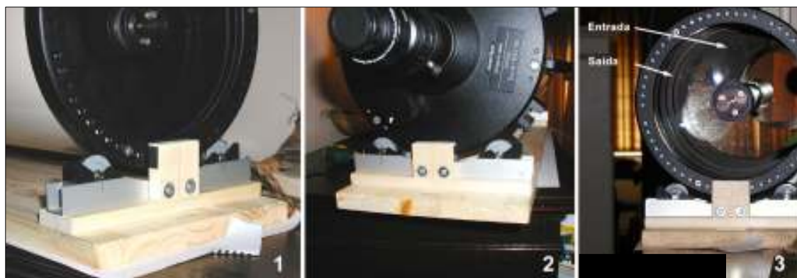
Fig. 6. Diferentes aspectos do dispositivo de colimação em acção. 1- parte frontal; 2- parte traseira; 3- entrada e saída do feixe no tubo (o ponto de incidência, no próprio espelho primário, não é visível nesta foto). Guilherme de Almeida (2007)
