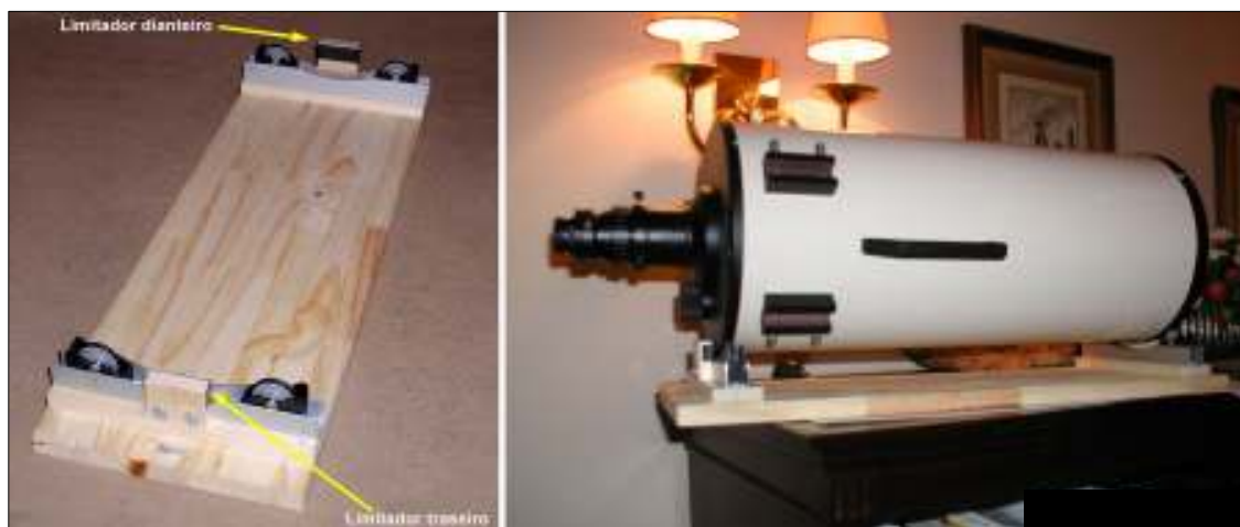
Fig. 5. Aspecto global do dispositivo, vendo-se as rodas (cinzentas), os seus suportes (pretos), a calha em "U", as réguas de madeira (de elevação) e os limitadores axiais. Guilherme de Almeida (2007)
