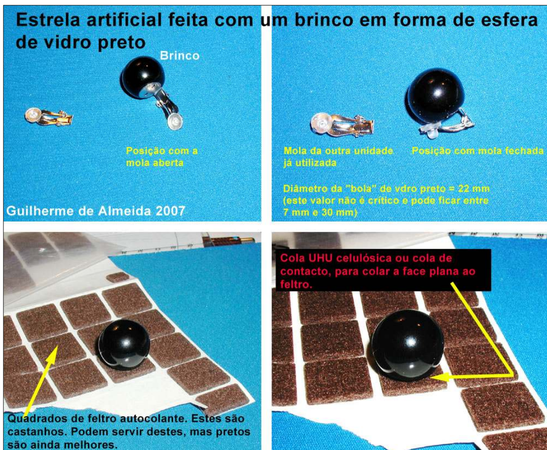
Fig.1. Diversos passos da construção da estrela artificial descrita neste artigo. O diâmetro da esfera não é crítico e pode situar-se entre cerca de 8 mm e 30 mm (Guilherme de Almeida, 2007).
