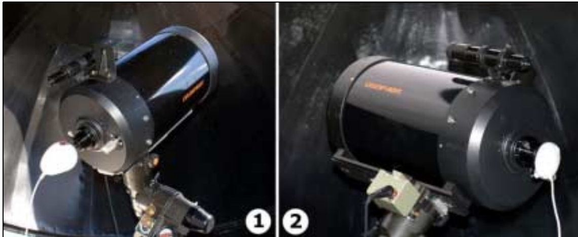
Figura 6- Duas Webcams adaptadas para astrofotografia. 1- Philipps Vesta Pro e 2- Toucam Pro . Pedro Ré (2002).
