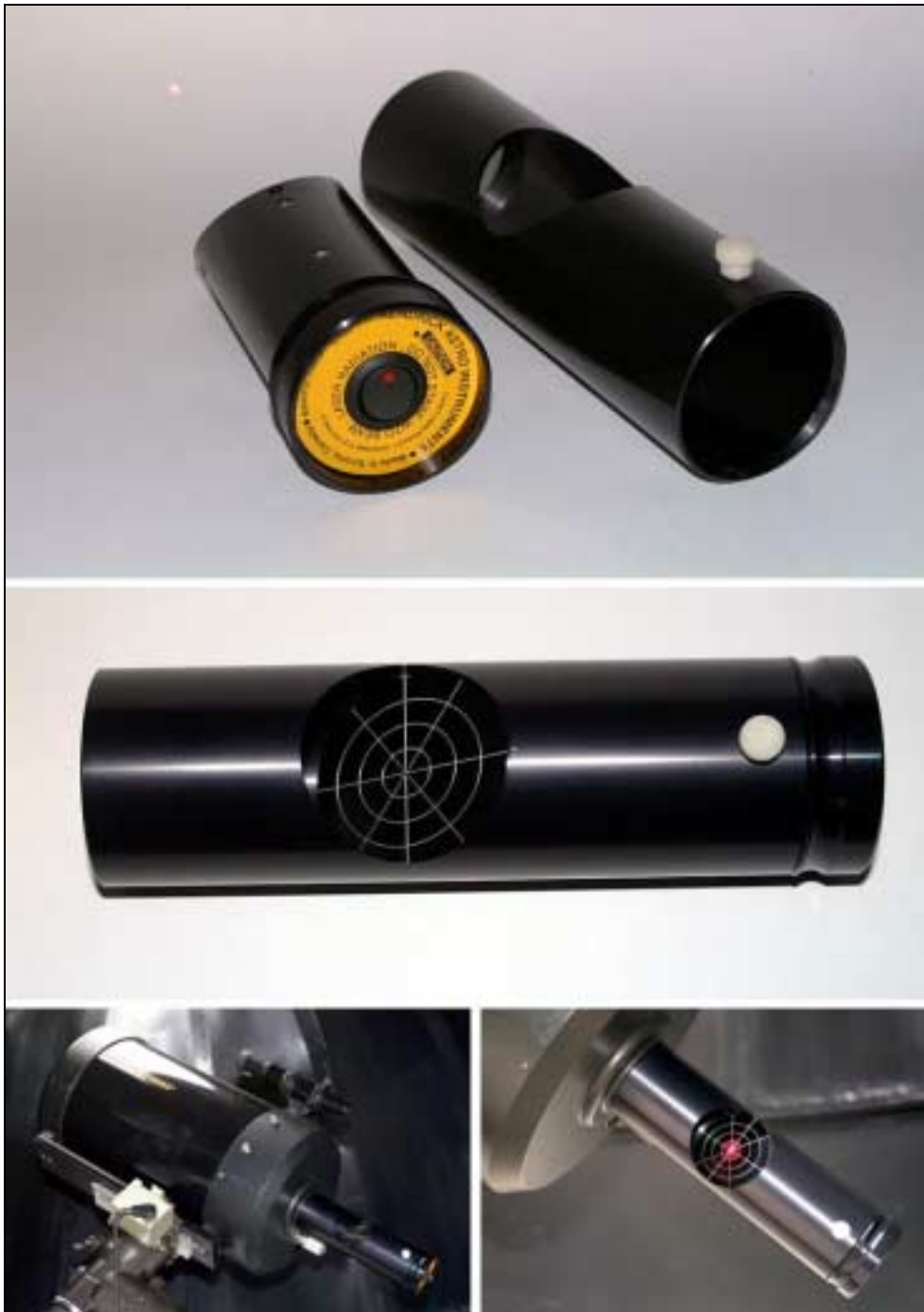
Figura 2- Colimador laser utilizado para alinhar os elementos ópticos de um telescópio Schmidt-Cassegrain. O uso destes dispositivos é útil para obter uma primeira colimação ou alinhamento dos componentes ópticos. O método mais preciso para colimar um telescópio consiste na observação nocturna de uma estrela tal como é referido no texto. Pedro Ré (2001).
