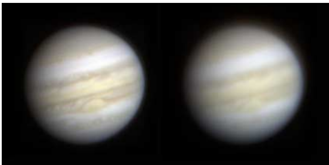
Figura 4- Simulação do efeito da descolimação em imagens planetárias (Júpiter). Telescópio Schmidt-Cassegrain 200 mm f/10 (turbulência 0,1). Imagens obtidas com um telescópio colimado (à esquerda) e descolimado (à direita). Imagens geradas com o auxílio do programa Aberrator 3.0 ( http://aberrator.astronomy.net/ ).
