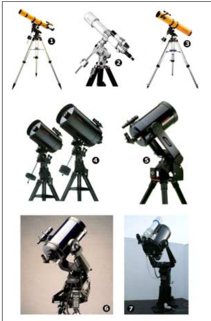
Figura 1- Exemplos de algumas montagens equatoriais: 1- Montagem alemã, refractor acromático Konus 100 f/10 ; 2- Montagem alemã EM-10, refractor apocromático Takahashi FS102; 3- Montagem alemã, reflector Konus 114 mm f/8 ; 4- Montagens alemãs CM1400 e CM1100, telescópios Schmidt-Cassegrain C11 e C14; 5- Montagem de garfo, telescópio Schmidt-Cassegrain C8; 6- Montagem de garfo, Meade LX200 10"; 7- Montagem de garfo, C14 e refractor apocromático Takahashi FS102. Pedro Ré (2001).
