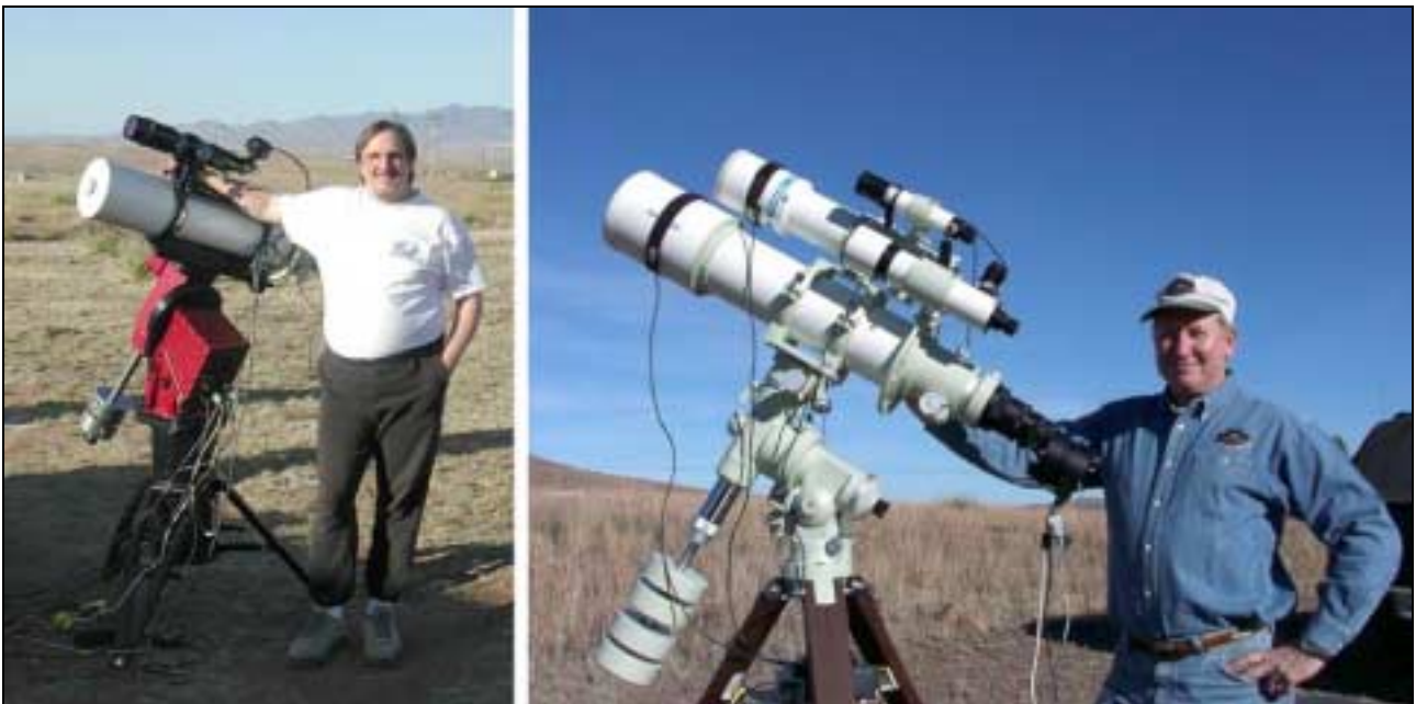
Figura 5- Montagens equatoriais fotográficas: à esquerda; Paramount, Takahashi FCT150; à direita NJP-160, Takahashi FCT150, FSQ106.
