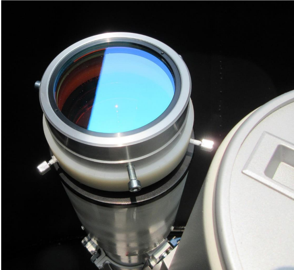
Figure 6- Baader 110 mm ERF (TMB 100 mm F/8).
